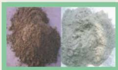
A cinza leve normalmente é pegajosa, contém uma considerável quantidade de resíduos não queimados e umidade. Após o uso de **THERMACT**, a cinza leve se torna um pó limpo, livre de umidade e flui livremente. A cor leve da cinza indica menos resíduos não queimados como resultado de uma combustão eficiente e completa do carvão.
