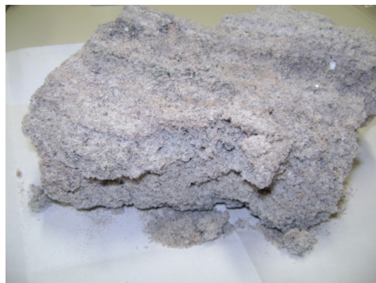
Leve, quebradiço e em menor quantidade (Com Thermact B)
