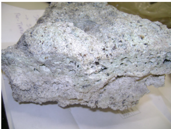
Clinker pesado e duro (Sem Thermact B)
