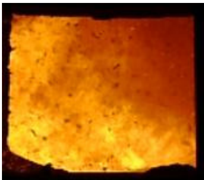
Chama escura – menor temperatura (Sem Thermact B)
